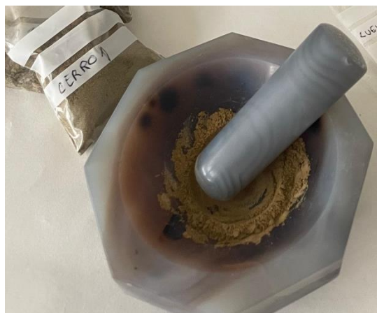
Ilustración 9. Muestra molida mediante el mortero de ágata.
